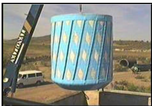
Fig 7.- Dispositivo tipo bala utilizado para la limpieza del A. Chapala
