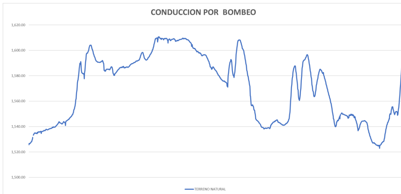
Lámina 5.2 Perfil topográfico de la línea de impulsión
