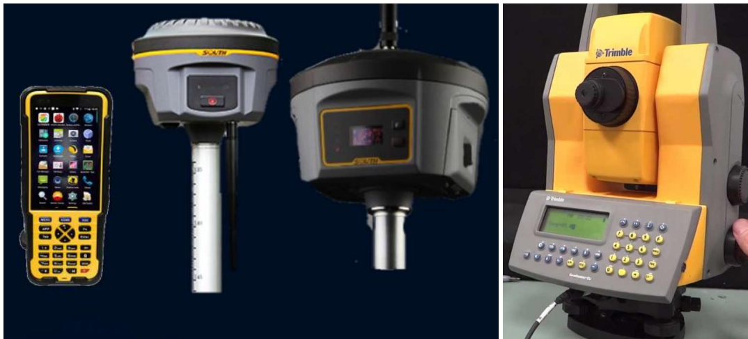
Figura 4.1 Equipo topográfico RTK GNSS SOUTH y Estación total marca TRIMBLE 5600
