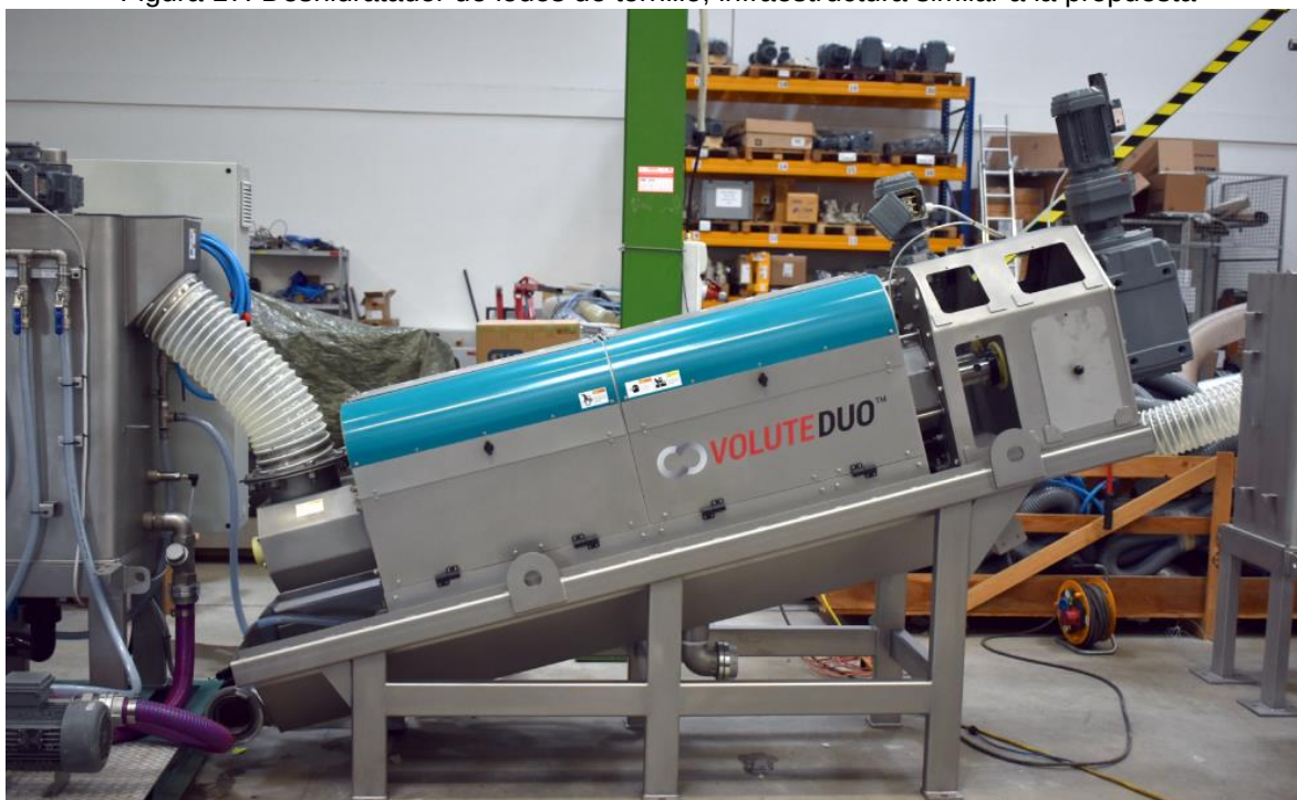
Figura 17. Deshidratador de lodos de tornillo, infraestructura similar a la propuesta
